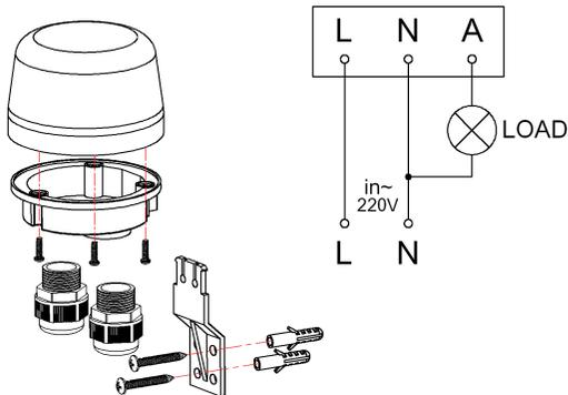
3. Montar el sensor en su posición correcta a través de los soportes.
